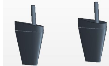
شکل ۲: سکان شناور DTMB 5415
