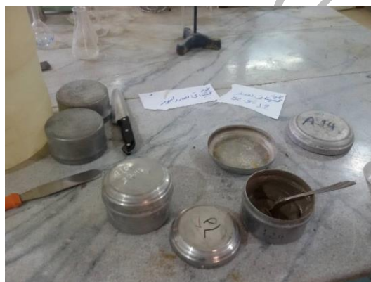
شکل ۴- فرایند عصاره‌گیری پس از ۴۰ دقیقه اشباع
