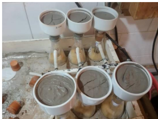
شکل ۶- انجام آزمایش‌های آنالیز تعیین یون‌های محلول
