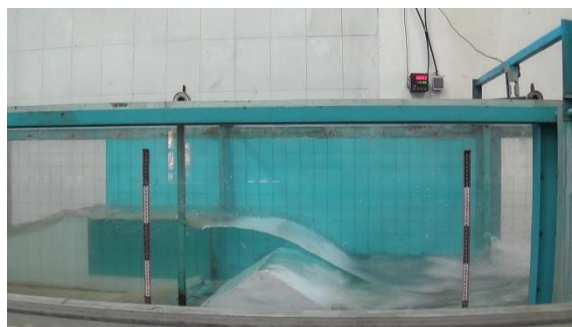
شکل ۴- برخورد و عبور آب از روی دایک در آزمایشگاه
