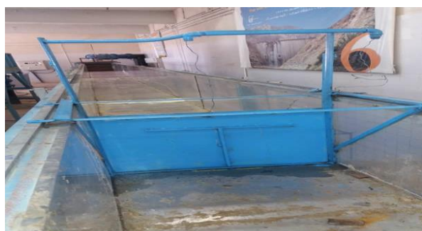
شکل ۳- نمایی از فلوم موج در آزمایشگاه هیدرولیک دانشگاه شهرکرد
