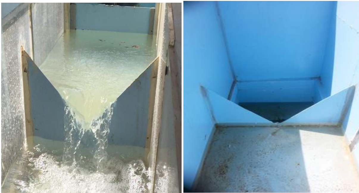
شکل ۲- سرریزهای ورودی و خروجی مثلثی با رأس ۹۰ درجه، در ابتدا و انتهای کانال آزمایشگاهی Fig. 2- Input and output 90° triangular weirs at the beginning and end of the flume
